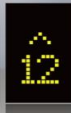
4.3EOD-LCD жидкокристаллический дисплей с желтыми пикселями
